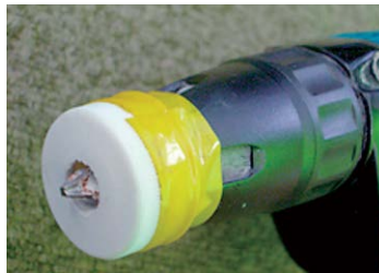
例：天井材保護の為ペットボトルのキャップを使用
