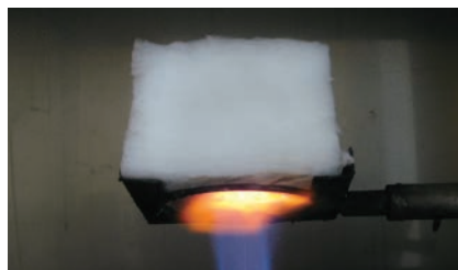
【比較方法】150mm角の試料をセットし、下から炎を当てた後の状態を撮影。
