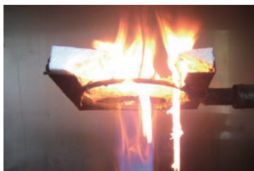
【比較方法】150mm角の試料をセットし、下から炎を当てた後の状態を撮影。
