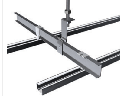
野縁の取付け3
