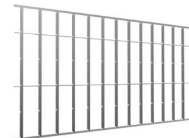
振れ止めの取付け
